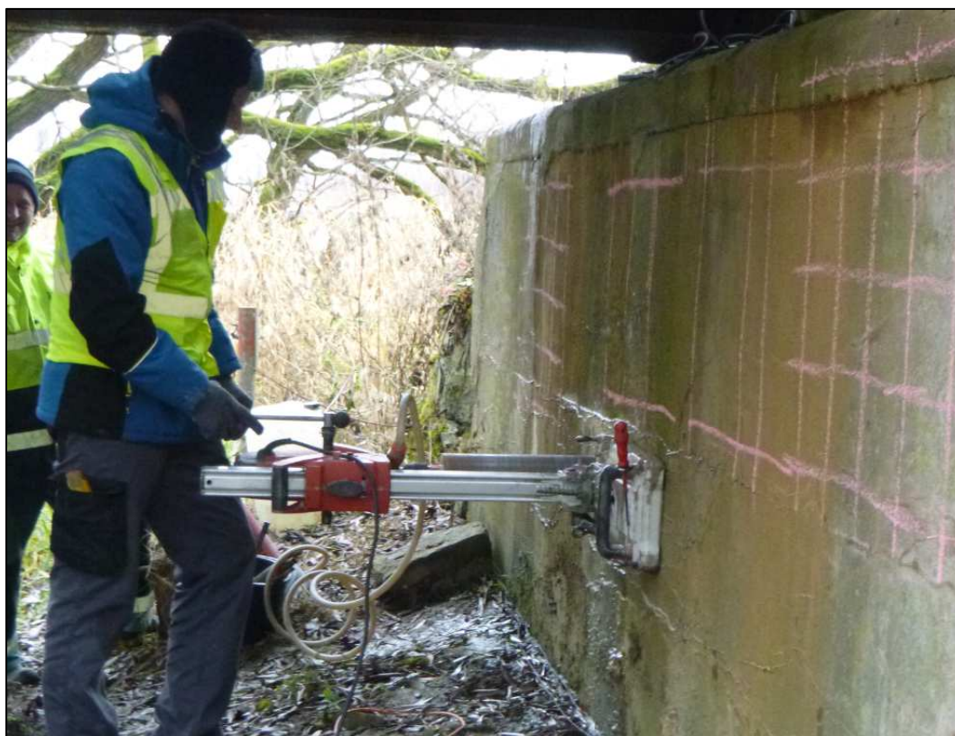
Obrázek 6 – odběr vzorků betonu na opěře 2
