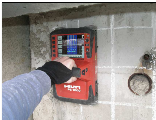
Obrázek 8 – RADAR HILTI PS1000 01X Concrete Pulse Radar.
